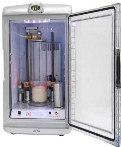
Rys. 1 Laserowy fermentograf Sadkiewicza Rys. 2 Przykład uzyskanego wykresu badanej próbki mąki Graham
